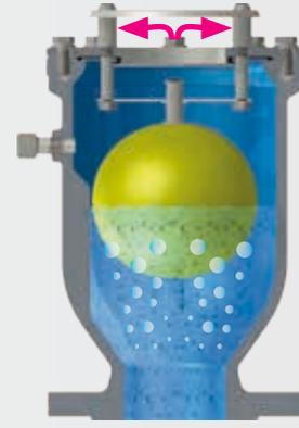
**TUBERÍA EN CARGA**
