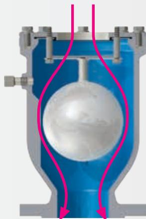
**VACIADO DE LA TUBERÍA**
